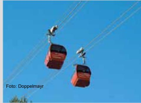
2-S-Bahnen haben deutlich geringere Investitionskosten als 3-S-Bahnen. Die Kabinen werden an einem Seil gezogen, das zweite dient der Führung (Tragseil).
