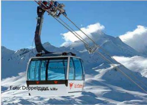
3-S-Bahnen sind Umlaufbahnen mit hoher Kapazität. Es bedarf nur weniger Stützen und somit geringer Flächeninanspruchnahme, da extrem lange Spannfeldlängen (bis 3.000m) realisiert werden können. Sie bieten hohen Komfort und Sicherheit.
