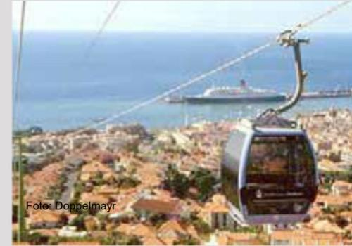
Einseilbahnen erfordern die geringsten Investitionen. Es gibt nur ein Förderseil. Daher werden mehr Stützen benötigt, da es kein Tragseil gibt. Windstabilität ist bis 70km/h gegeben. Sie eignen sich besonders für die als Feeder zu größeren ÖPNV-Systemen.
