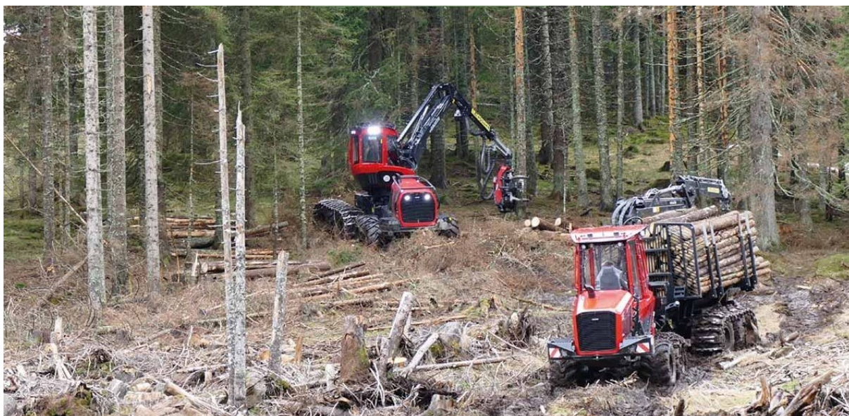
Fig. 5 – Sistema di esbosco completamente meccanizzato con harvester che esegue taglio di abbattimento, allestimento e concentramento e forwarder che si occupa dell’esbosco trasportando all’imposto il legname. In questo sistema non è previsto un operatore con motosega, con un maggiore livello di sicurezza sul lavoro (fonte: Di Marzio et al., 2024).
