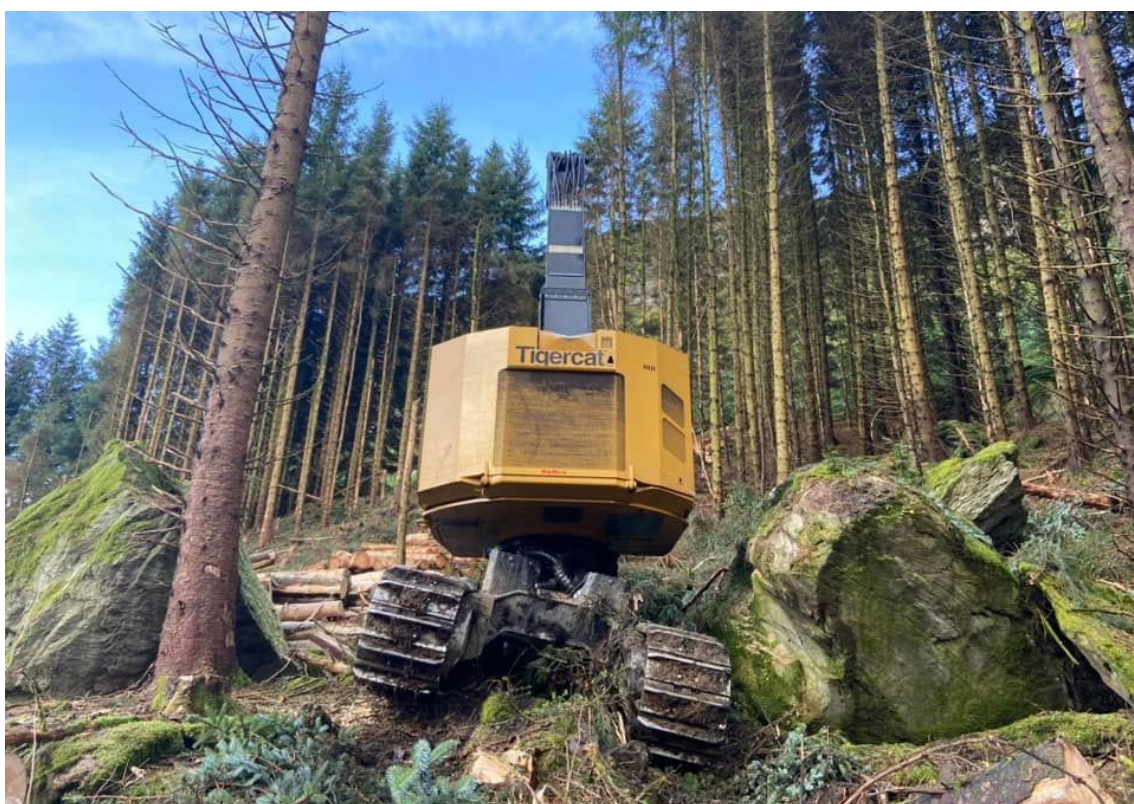
Fig. 4 – Harvester specializzati per pendenze elevate e terreni accidentati: Konrad Highlander (sopra, Alto Adige) e Tigercat (sotto). Rispetto agli harvester convenzionali questi si muovono con maggiore agilità nelle zone più difficili (fonte: Forest Machine Magazine).
