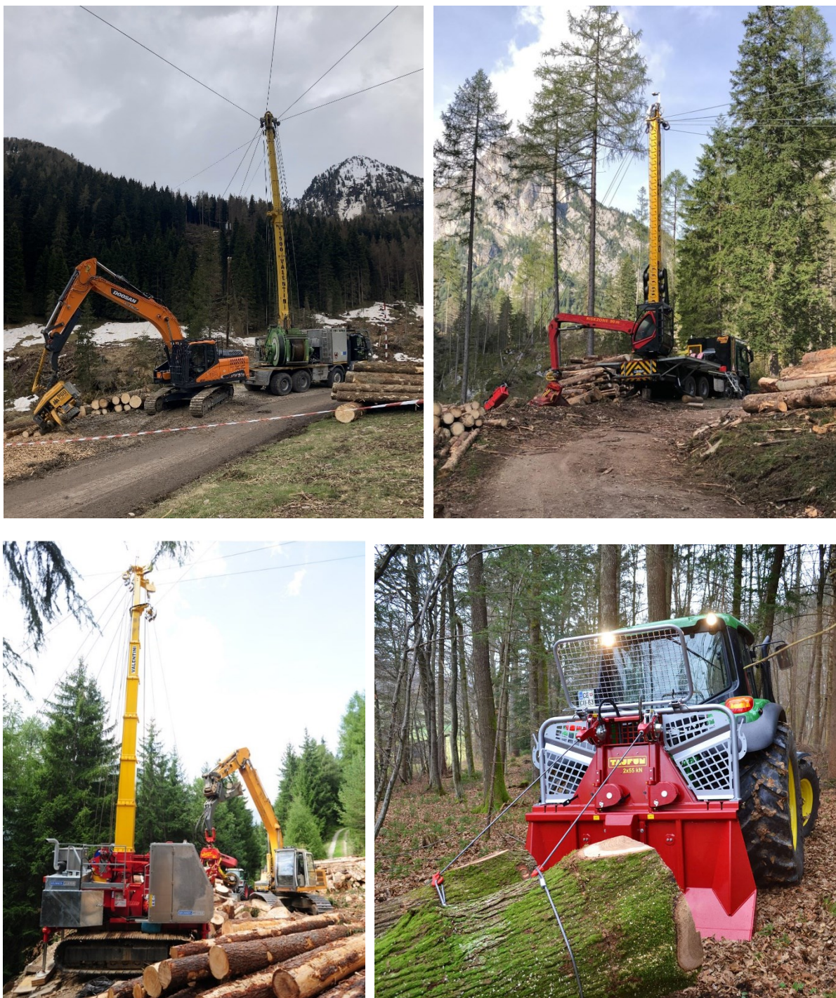
Fig. 3 – Esempi di sistemi di esbosco utilizzati nelle Alpi orientali italiane. Le gru a cavo montate su motrice possono disporre di un processore integrato (sopra a destra: Konrad Mounty 5000 a Malga Ciapela, BL; fonte: scrivente) oppure possono essere abbinate ad un escavatore con processore (sopra a sinistra: Valentini V1500 su Astra a P.sso Manghen, TN; fonte: scrivente). Le gru a cavo più contenute devono essere abbinate ad un processore montato su escavatore (sotto a sinistra: Valentini V600; fonte: Valentini Teleferiche). I sistemi più tradizionali prevedono l'utilizzo di trattore forestale allestito con verricello forestale (sotto a destra: verricello Tajfun 2x55 kN; fonte: Tajfun).
